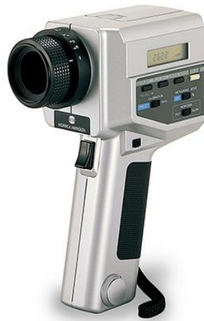
ภาพที่ 4 เครื่องมือวัดสีและความสว่างยี่ห้อ Konica Minolta รุ่น Chroma Meter CS-100A ที่มา: https://sensing.konicaminolta.asia/product/discontinued-cs-100a-color-and-luminance-meter/
