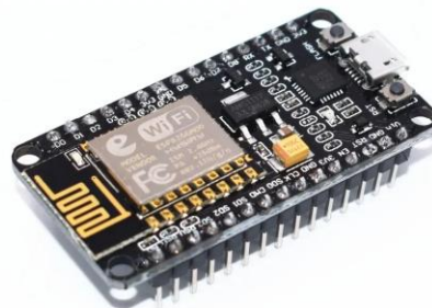
ภาพที่ 1 อุปกรณ์ไมโครคอนโทรลเลอร์ NodeMCU ESP8266
