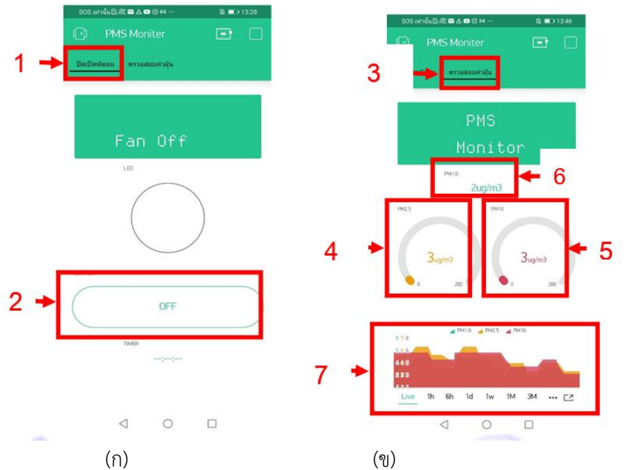
ภาพที่ 10 (ก) การควบคุมการทำงานในการเปิด-ปิด พัดลมดูดอากาศ (ข) หน้าการแจ้งปริมาณของฝุ่นละออง
