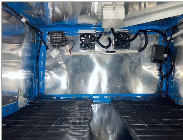
ภาพที่ 8 ระบบควบคุมความชื้นและระบบควบคุมอุณหภูมิภายใน
