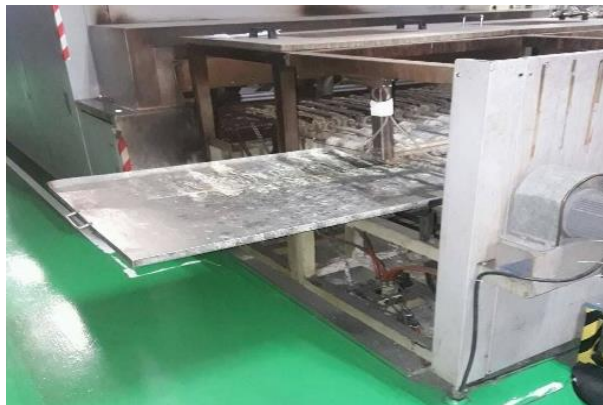
ภาพที่ 8 ตำแหน่งที่แทรกถาดเพื่อรองรับน้ำยาและป้องกันการปนเปื้อนน้ำมันและจารบี
