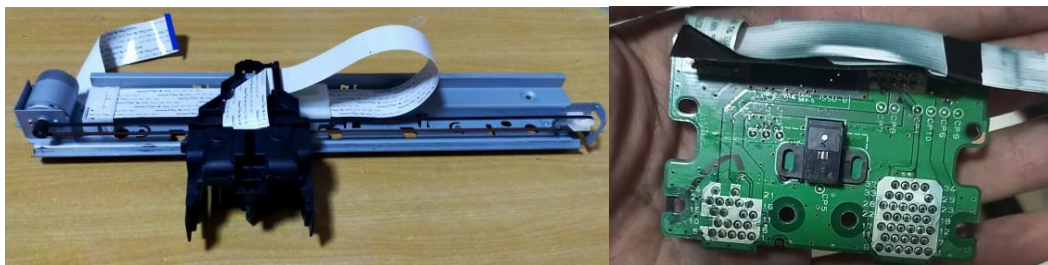
ภาพที่ 10 รางเลื่อนเชิงเส้น และ ตัวเข้ารหัสเชิงเส้น
