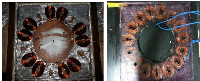
ภาพที่ 3 การขึ้นรูปชุดวงจรของขดลวดเหนี่ยวนำด้วยเรซิน
