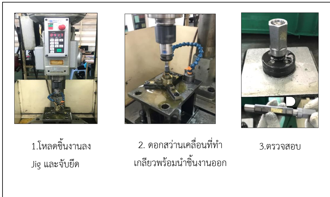
ภาพที่ 11 กระบวนการทำเกลียวชิ้นงาน NUT 7401 หลังปรับปรุง
