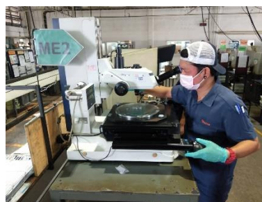
ภาพที่ 11 การวัดขนาดชิ้นงานหลังการทดลอง
