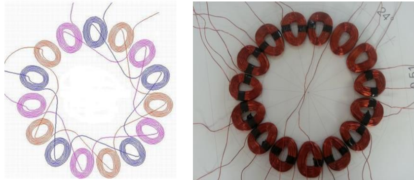
ภาพที่ 2 การต่อวงจรขดลวดเหนี่ยวนำหรือขดลวดอาร์เมเจอร์
