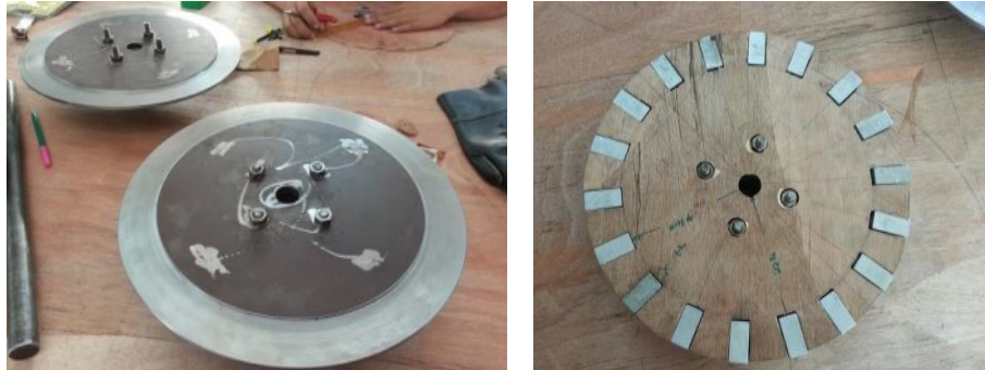
ภาพที่ 4 แผ่นเหล็กโรเตอร์ติดตั้งแม่เหล็กถาวร
