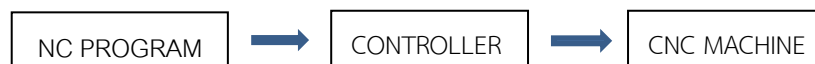
ภาพที่ 1 หลักการทำงานของเครื่องจักรซีเอ็นซี
