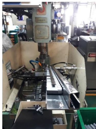
ภาพที่ 7 ติดตั้งเครื่องนำชิ้นงานเข้าเครื่องอัตโนมัติ เข้ากับเครื่องทำเกลียว
