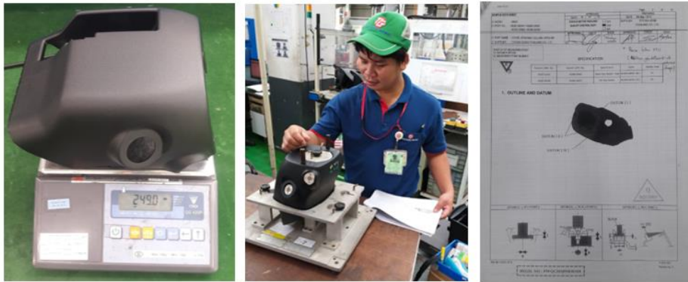
ภาพที่ 7 การตรวจสอบคุณภาพชิ้นงานหลังการแก้ไข Runner Gate โดยฝ่ายประกันคุณภาพ
