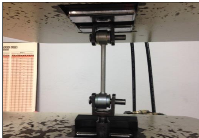
ภาพที่ 2 การทดสอบชิ้นงานด้วยเครื่องทดสอบแรงดึง
